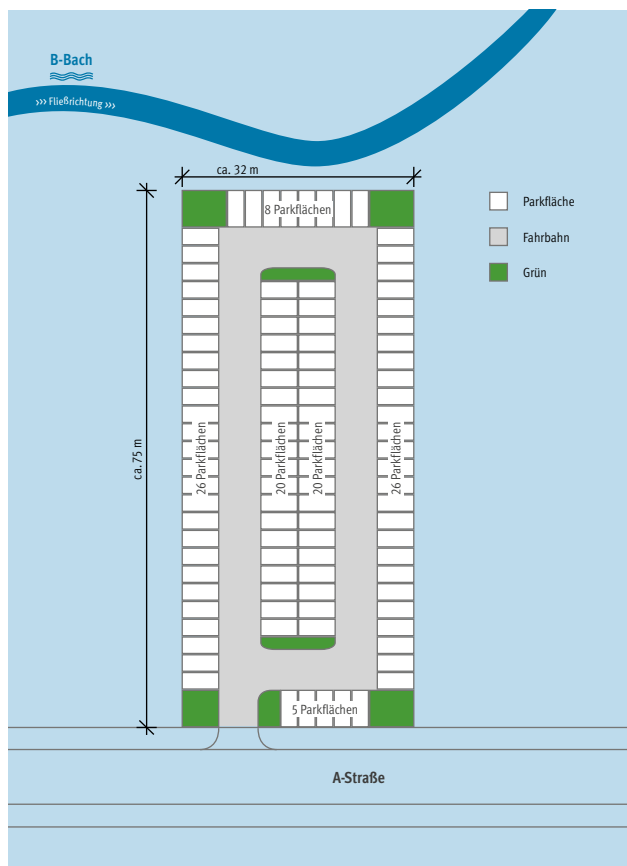
Abb. 38: Musterparkplatz (Variante 1), die Flächenversickerung mit ECOSAVE protect
