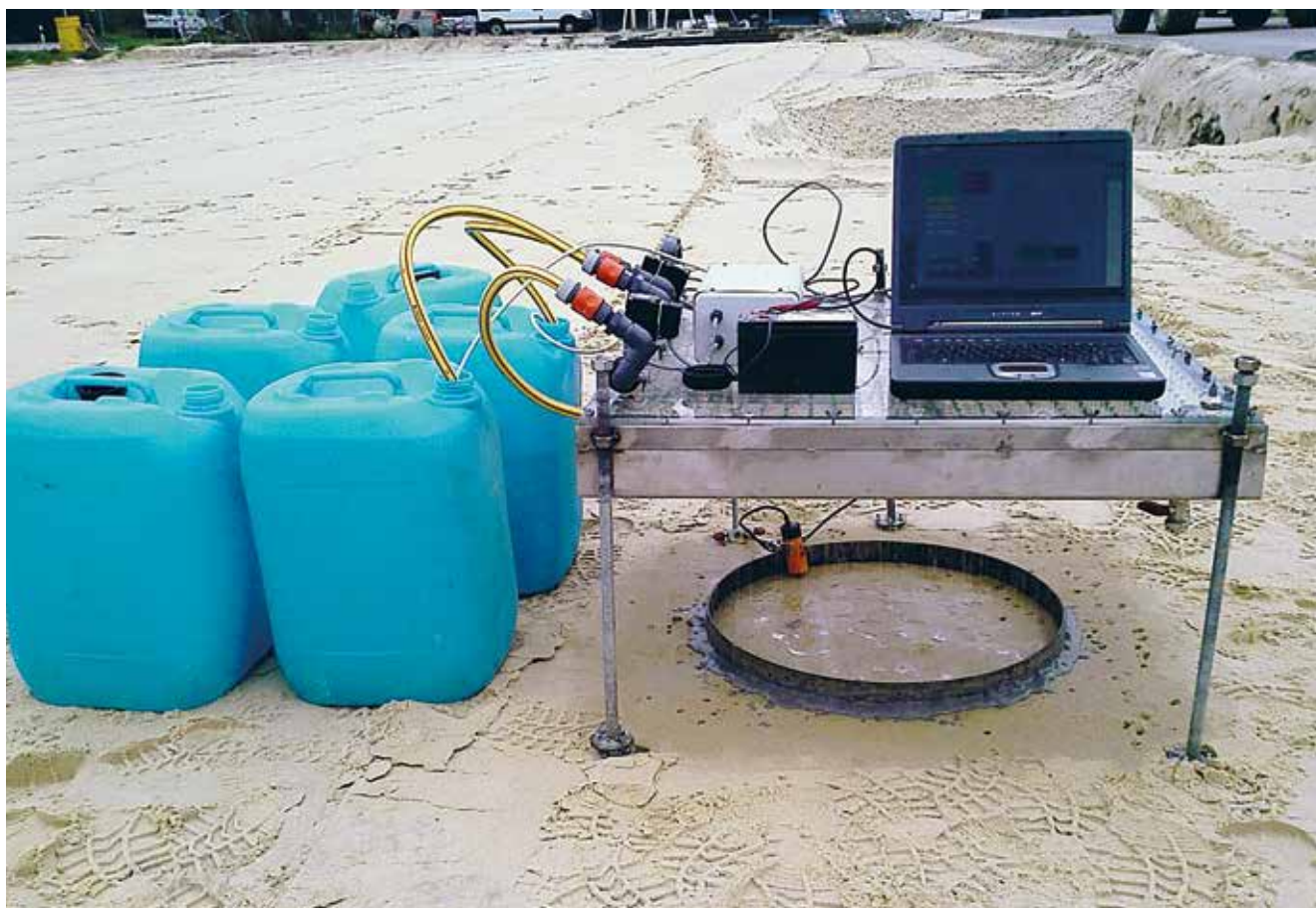
Abb. 14: Prüfung der Wasserdurchlässigkeit mit dem Tropfinfiltrometer
