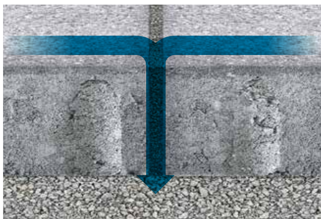
Abb. 29a: -gd protect: Das Regenwasser versickert ausschließlich über die Fugen.
