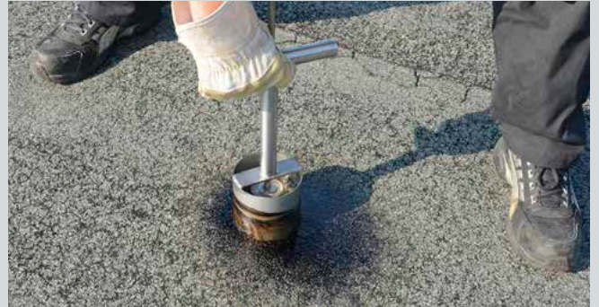
Abb. 17/1: Mit Spezialwerkzeug wird ein Schichtenpaket komplett ausgeschnitten.
