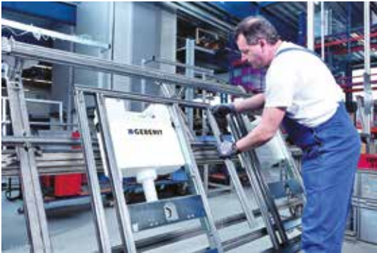
Abbildung 29: Montage der Sanitäreinheiten im Werk
