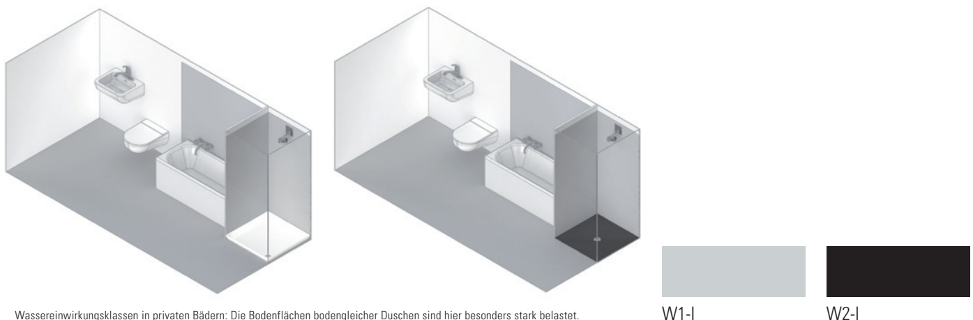
Wassereinwirkungsklassen in privaten Bädern: Die Bodenflächen bodengleicher Duschen sind hier besonders stark belastet.
