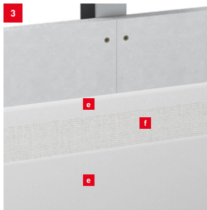
Systemaufbau der Beschichtung mit Spachteltechnik
